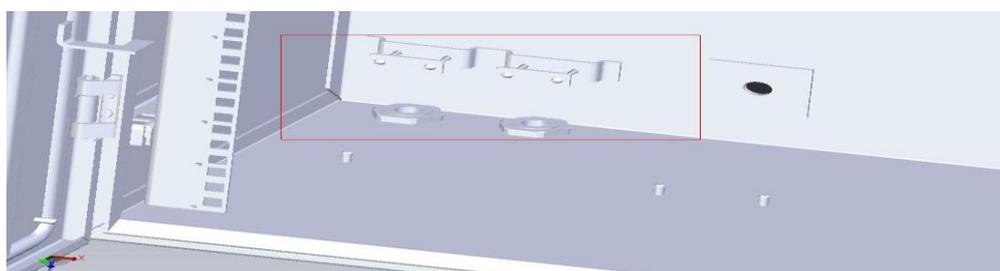
Рисунок 3. Ввод оптического кабеля
